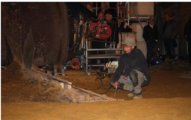
Préparation de la coulée : nettoyage du conduit et préparation du métal en fusion
