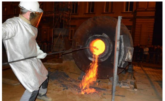
Préparation de la coulée : nettoyage du conduit et préparation du métal en fusion
